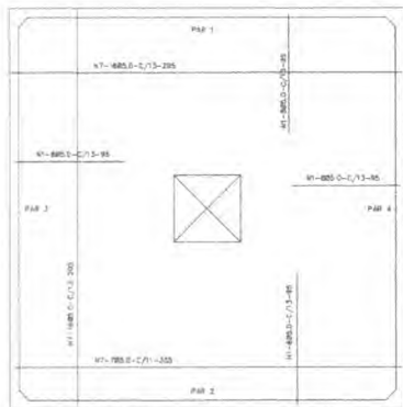
CX. D'ÁGUA - ARMADURA - DA TAMPA ESCALA 1/20
