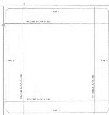
CX. D'ÁGUA - ARMADURA - DO FUNDO ESCALA 1/20
